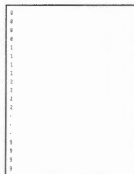
図 4 ファイル構成テキスト。数字一つが一つのファイルに対応し、各数字は光源方向を表している。5~9 は右上・右下・左下・左上の光源を表す。基本的には 4 方向で十分な効果が得られる。サーバでは画像ファイルを昇順にソートするので、登録前にソートした上で、画像の光源方向を確認し数字を記述する。同じ数字のファイルは全て平均化される。
