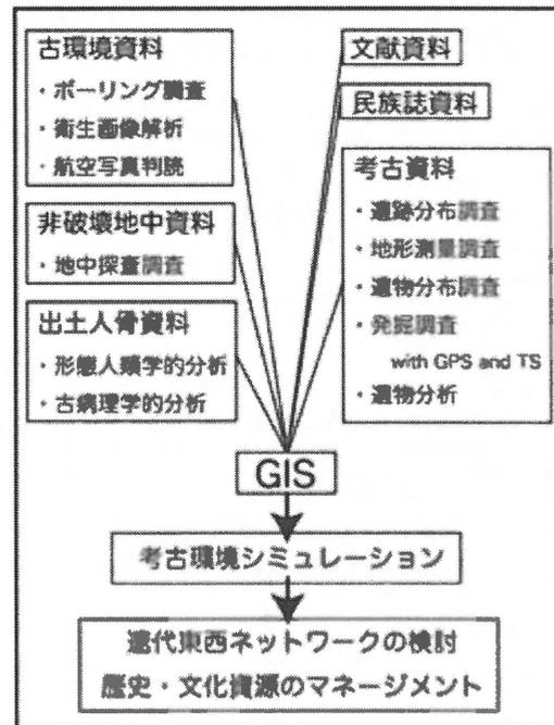
図2 GISを利用した調査情報の統合システム
