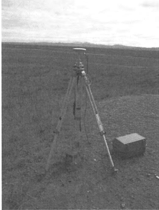
写真1 基準点の STATIC 測量
