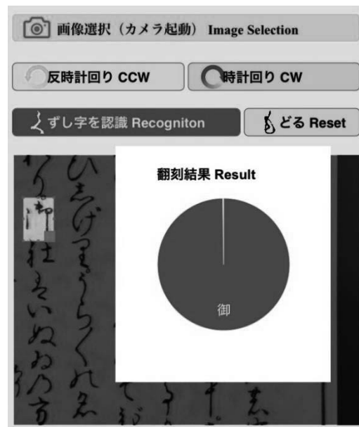
図1 CNNによるくずし字認識用 WWWアプリケーションのスクリーンショット例
